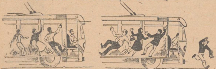
Fig. 71.— Al partir bruscamente, los pasajeros se van hacia atrás y hacia adelante si el vehículo frena de repente.
